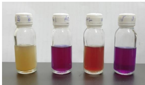
(ซ) น้ำเสียก่อนการบำบัด-มีเชื้อโรค (ณ) น้ำดี 1-ไม่มีเชื้อโรค (ญ) น้ำดี 2-ไม่มี (ฎ) น้ำดื่มปกติ-ไม่มี ภาพที่ 4.2 ผลการทดสอบการบำบัดน้ำเสีย
