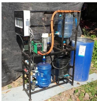
ภาพที่ 4-1 แสดงโครงสร้างของเครื่องบำบัดน้ำเสียจากฟาร์มปศุสัตว์ด้วยระบบอิเล็กทรอนิกส์ร่วมกับระบบนาโนไอโซนและรังสียูวีซี
