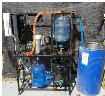
ภาพที่ 4-1 แสดงโครงสร้างของเครื่องบำบัดน้ำเสียจากฟาร์มปศุสัตว์ด้วยระบบอิเล็กทรอนิกส์ร่วมกับระบบนาโนไอโซนและรังสียูวีซี
